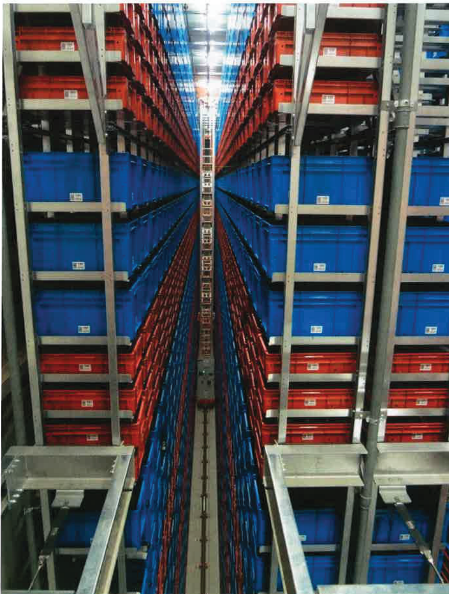
Das automatische Kleinteilelager ist einer von vier Lagerbereichen des Zentrallagers in Dietikon, der vom Lagerführungssystem LFS gesteuert wird. (Bild: Ehrhardt + Partner)
